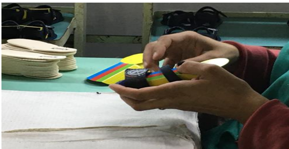
Foto 16 – Acabamento do calçado, introduzindo palmilha interna.
