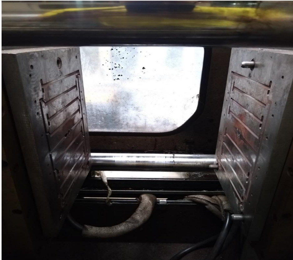
Foto 10 – Máquina Injetora para solado bicolor
