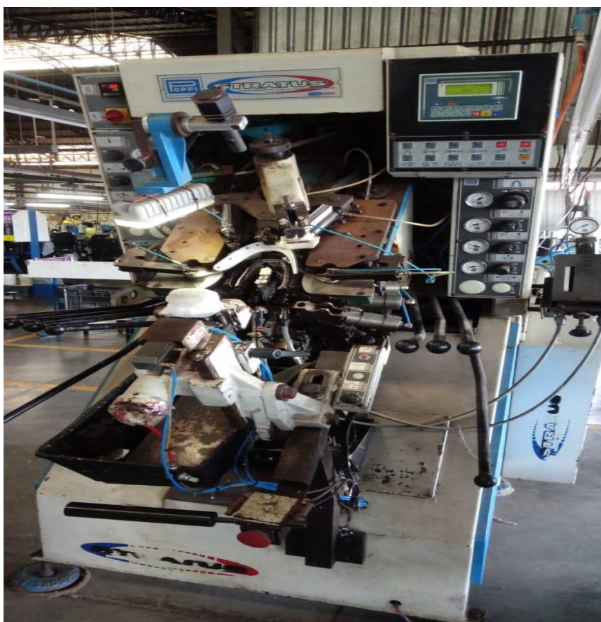
Foto 13 – Máquina de Montar o bico do calçado.
