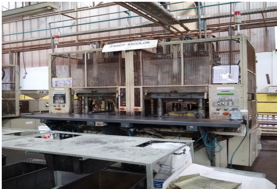
Foto 10 – Máquina Injetora para solado bicolor
