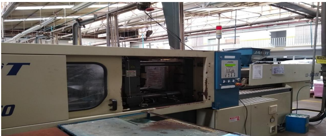
Foto 08 – Máquina Injetora para solado monocolor
