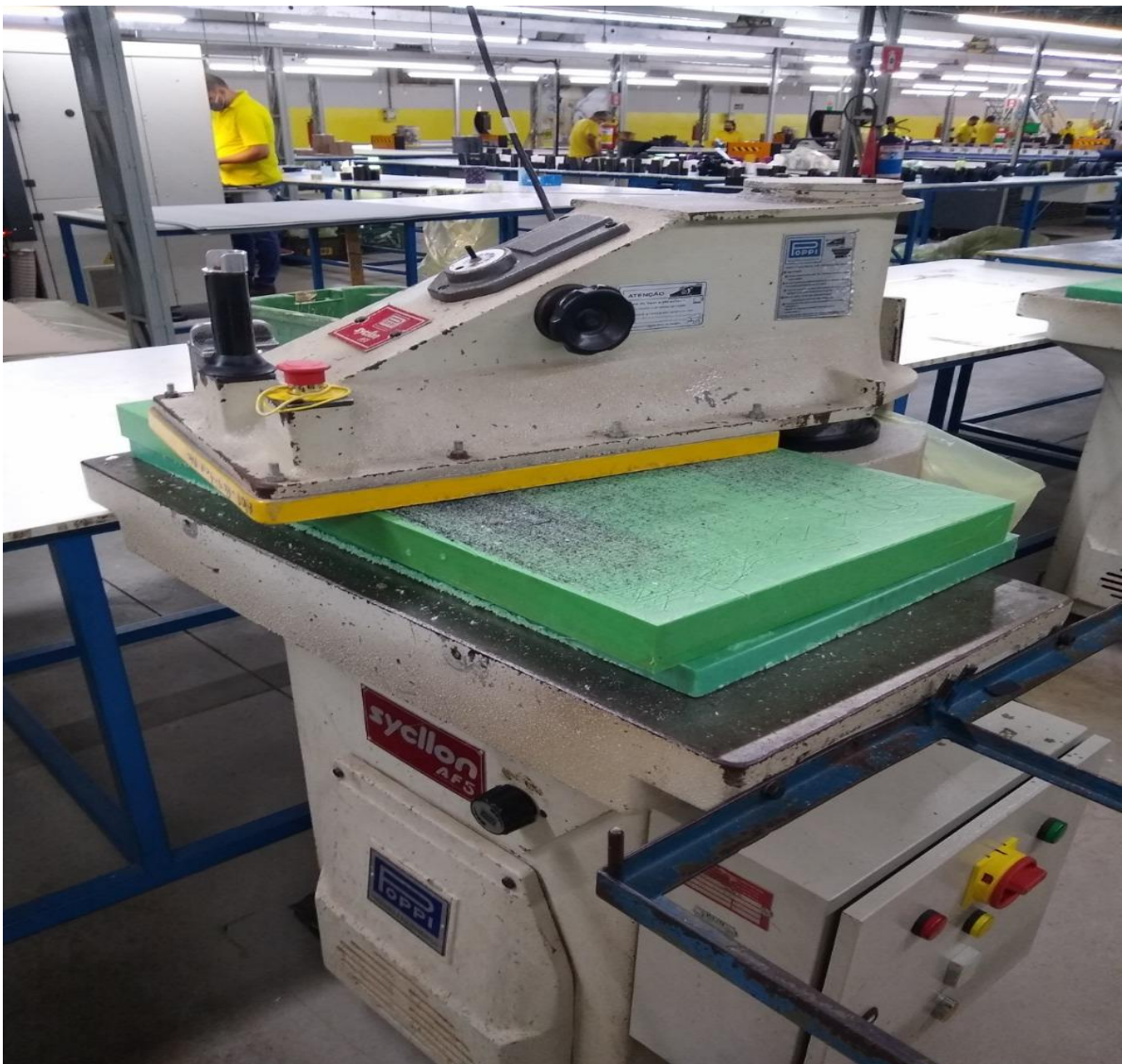
Foto 02 – Balancim (Prensa Hidráulica) para corte de calçados.
