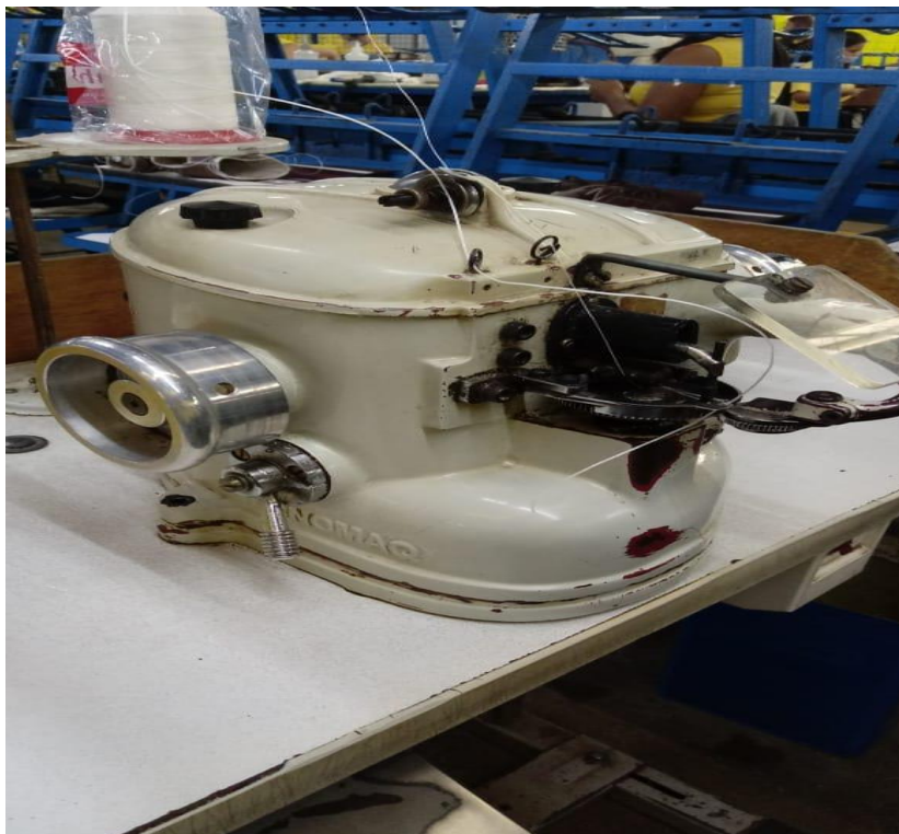
Foto 13 – Máquina de Montar o bico do calçado.
